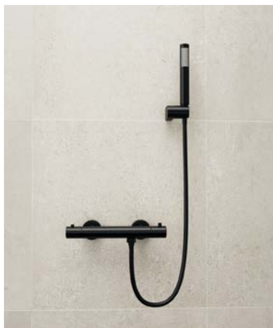
Corpo miscelatore ottone nero opaco Cartuccia termostatica sensor Vernet Flesso 1,5M PVC antitorsione Sistema antiscottaturas
